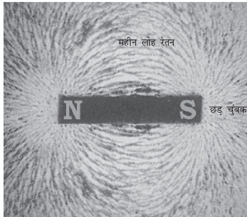
चित्र 10.11.2 गत्ते पर चुंबक तथा लोह रेतन का उपयोग करके चुंबकीय क्षेत्र रेखाएं दर्शाने की व्यवस्था
