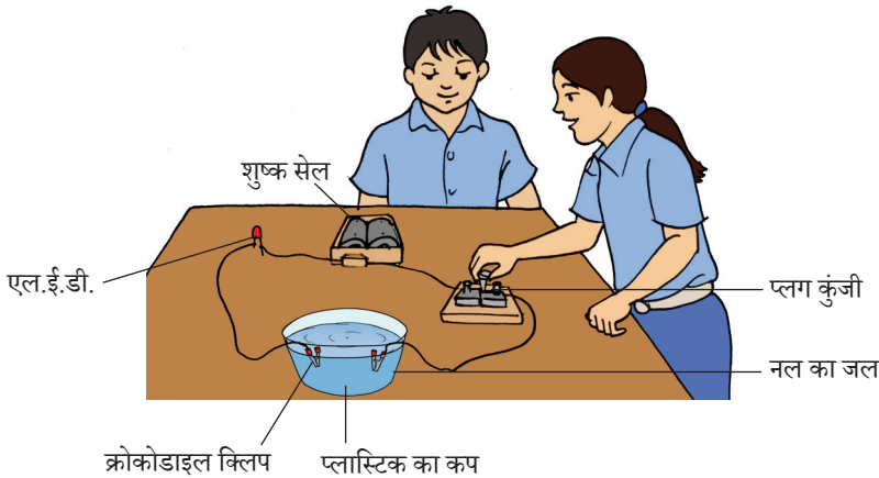
चित्र 6.10.4 — नल के जल की विद्युत चालकता जाँचने के लिए परिपथ युक्त व्यवस्था
